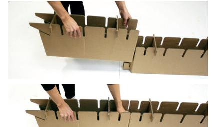
Die Stützen so verbinden, dass sie sich ergänzen (Verbinden mit Teil D)
