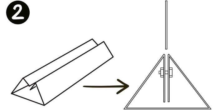
Die Stützbeine werden zum Dreieck zusammengefaltet und mit den Schrauben arretiert.
