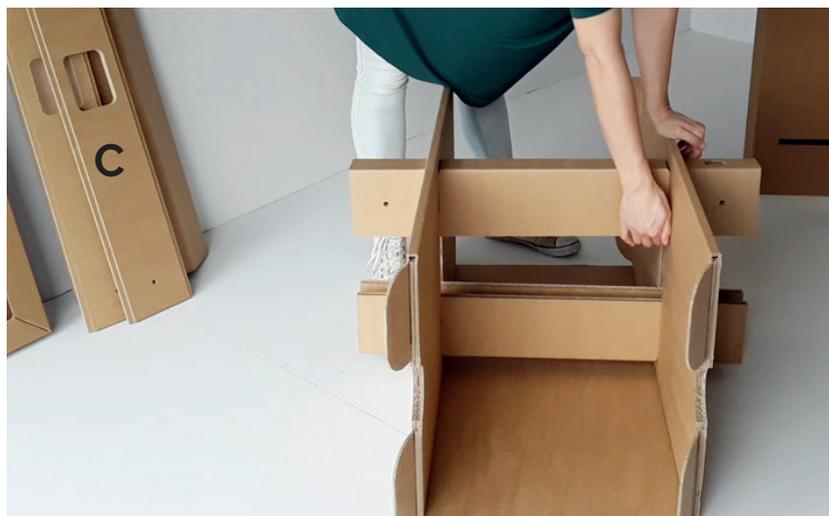
Die Schlitz müssen bis zum Ende ineinander greifen - sonst passen die Schwerter später nicht dazwischen. Sollte es beim Einschieben der Schwerter schwer gehen, einfach noch mal prüfen, ob die Mittelstützen richtig sitzen.
