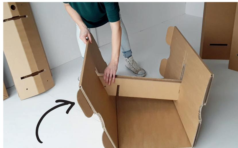
Die runden Laschen an den kurzen Seiten müssen später nach unten zeigen. Die Kabellöcher in den Mittelstützen müssen oben sitzen.
