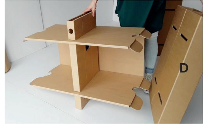
Außenstützen ansetzen: die runden Laschen des Korpus in die Schlitzte einschieben.
